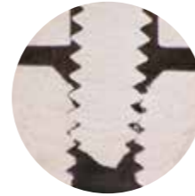
山頂のシーム(継ぎ目)にオネジ山頂が噛み込んでしまう問題がなくなります。
