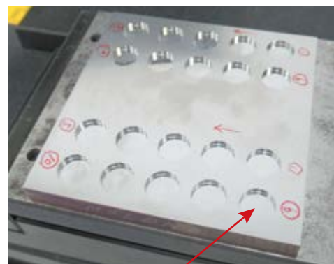
加工形状 Machining shape \phi 8.8 \times 深さ Depth 1.5mm
