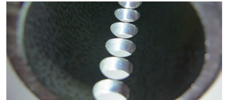
SGP-E-H バイブ 湿式穿孔 S=1280 F=51 V=24.1 f=0.039
